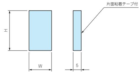
■ 基板をケースに固定する際にスポンジ面で挟んだり、粘着テープ面で固定することができます。使い方により様々な用途にご利用頂けます。
