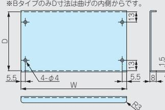
中型から大型のケースに適しています。W方向（パネル面）が広いタイプで重量のある物を載せる場合などシャーシのたわみを防ぎたい場合に選定して下さい。
