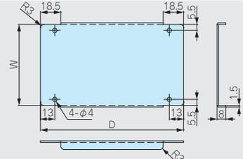
中型から大型のケースに適しています。D方向（奥行き）が広いタイプで重量のある物を載せる場合などシャーシのたわみを防ぎたい場合に選定して下さい。
