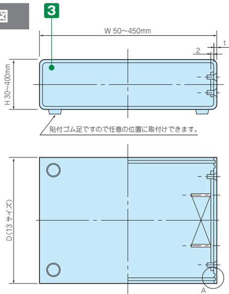
■ A詳細と寸法はP9-100の上下カバー断面図をご参照下さい。
