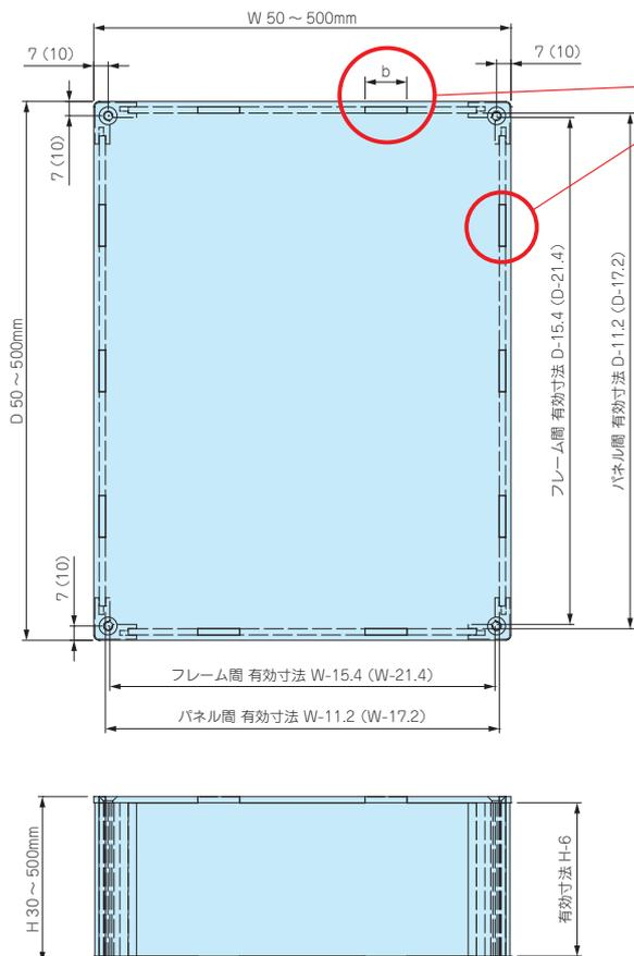
幅(W)、奥行き(D)寸法によりハメ込み部bの寸法、箇所数が異なります。下記表をご確認下さい。
