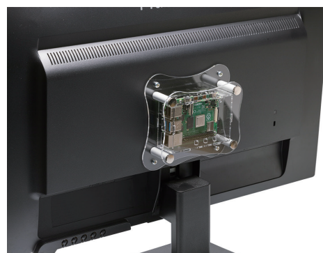
RPA-4B-1FはVESA規格の取付ピッチ(100×100mm)に対応しており、PCディスプレイの裏側などに取付が可能です。
