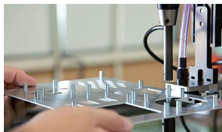
タカチでは専用のプレス機で加工をしますので、安定した強度でスペーサーの取付が可能です。
