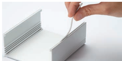
■ ガスケットは下カバー凹合溝に入れ込んで下さい。
