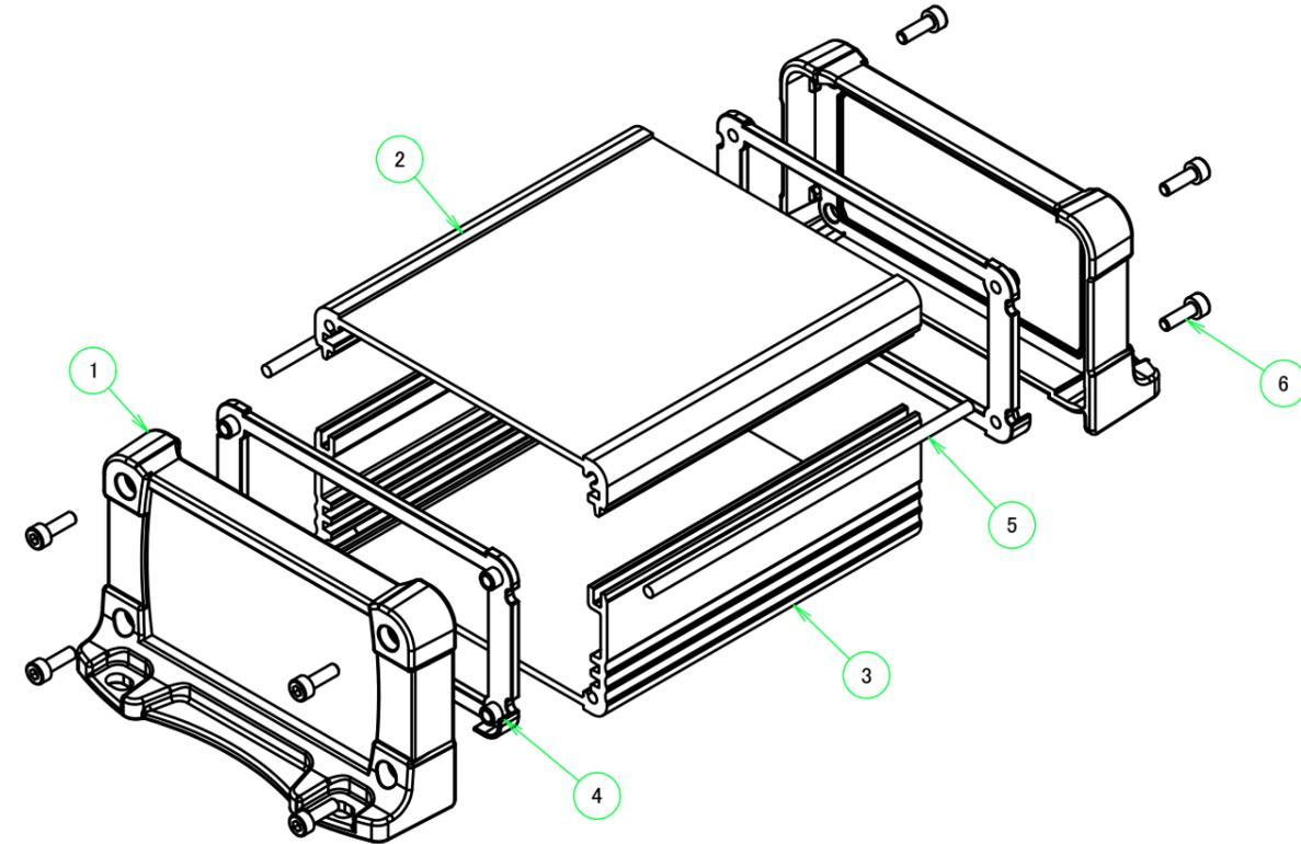
※取付ビスの締付けの強弱によりガスケットが伸縮するためD寸法(全長)は多少変化します。
