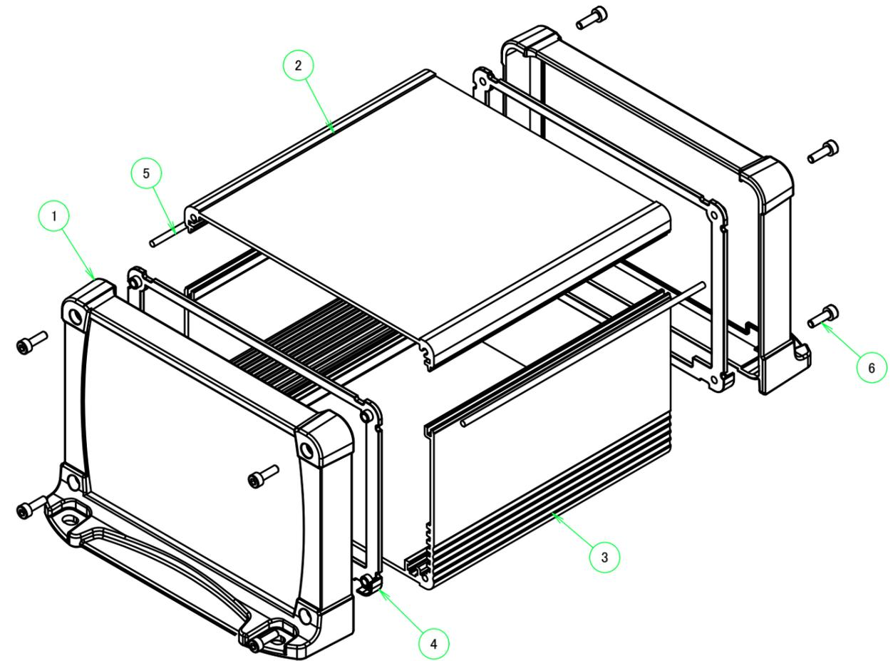
※取付ビスの締付けの強弱によりガスケットが伸縮するためD寸法(全長)は多少変化します。
